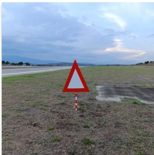
Señales de referencia visual instalada a 400 m de la pista 16 SKCC
